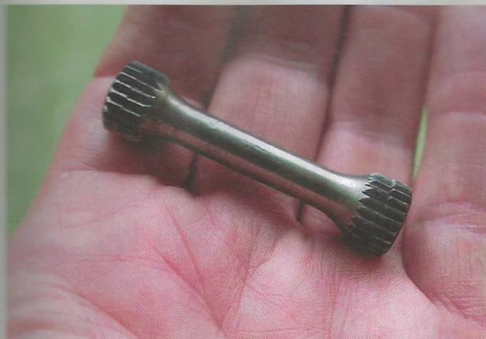
Aksten, der trækker olie-pumpen, kan knække!
