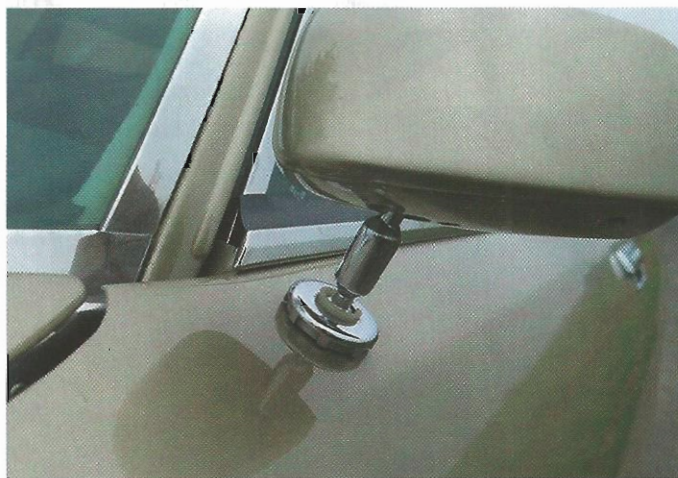
På en SM er spejlene er skruet fast i et gevindstykke under dørpladen - præcist som de også er det på en Citroën GS.
